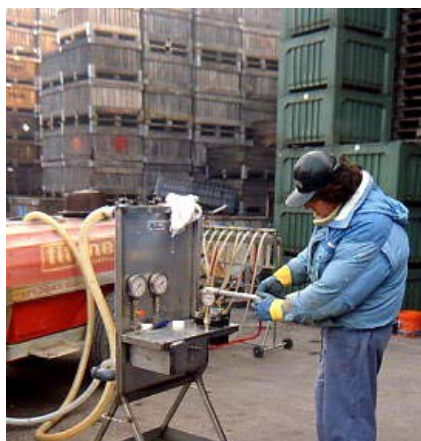
Foto 1. Verifica efficienza del manometro
