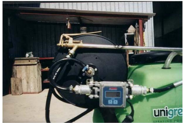
*foto 15. Flussometro elettromagnetico applicato alla motopompa carrellata*
