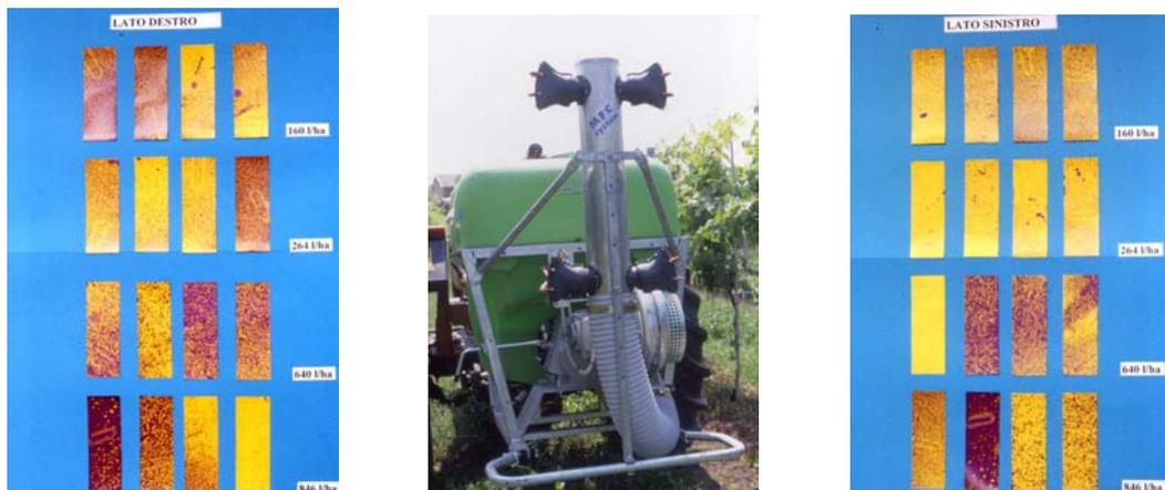
*Foto 2-3-4 . Cartine idrosensibili utilizzate per la determinazione del grado di copertura. Irroratrice impiegata nelle tesi a basso volume*
