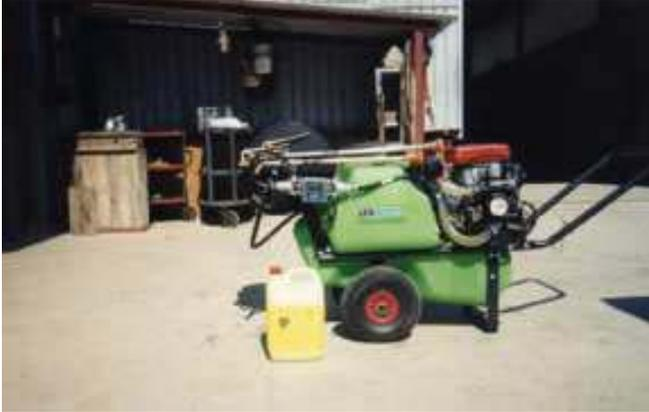
*Foto 17. Motopompa carrellata utilizzata per le prove di bagnatura*
