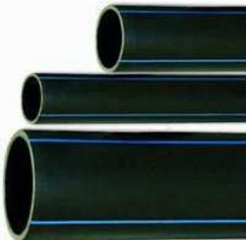
In vigneto può essere costituita da due tipi di plastiche differenti: *Polietilene ad alta densità* (PEAD) o *Poli-vinil cloruro* (PVC). Il PEAD mostra caratteristiche tecniche e prestazioni di poco maggiori al PVC, ma si adatta molto bene in tutti i tipi di terreni e se fornito in bobine risulta molto comodo in fase di posa (no giunzioni). Il PVC viene fornito invece in verghe con raccordi a bicchiere, ideale per la posa in piano ed è sensibilmente più economico del PEAD.
