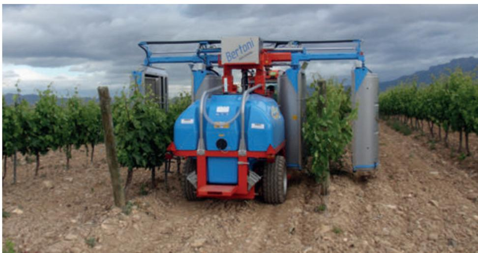
Figura 15. Trattamento in vigneto con irroratrice a tunnel (Fonte: Bertoni Srl)
