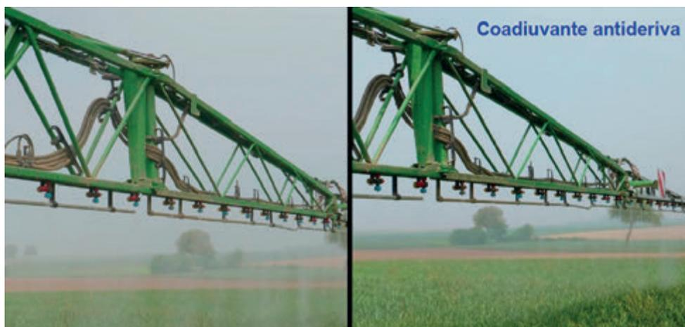
Figura 8. Applicazione fitoitarica senza l'impiego di un coadiuvante antideriva (immagine a sinistra) a confronto con trattamento che lo prevede (immagine di destra).
