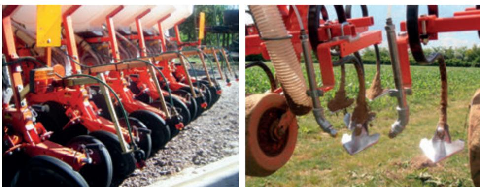
Figura 11. Irroratrice abbinata a seminatrice (sinistra) e irroratrice abbinata a sarchiatrice (destra).
