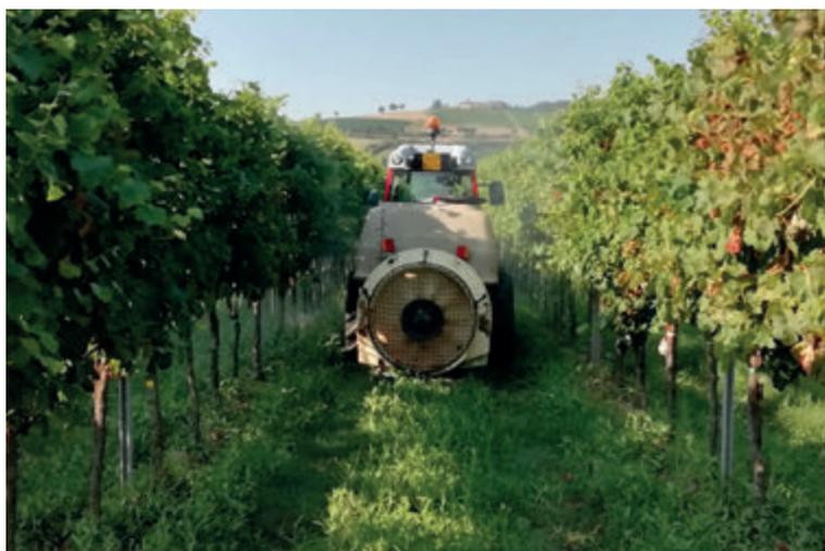
Figura 1. Trattamento alla vite con atomizzatore portato (Foto A.Franchi)
