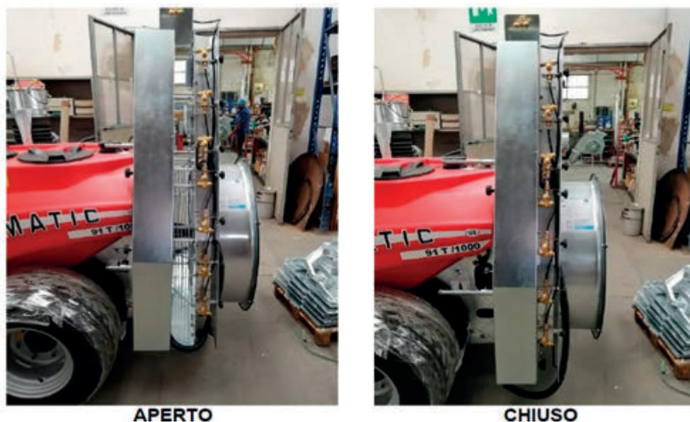
Figura 14. Schermo per la chiusura del flusso d'aria prodotto dalla ventola (Fonte SAE 1946 Srl).
