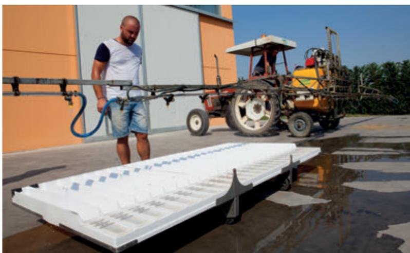
Figura 16. Determinazione della corretta altezza di lavoro su barra irroratrice (Fonte: Bulzoni Meccanica sas).
