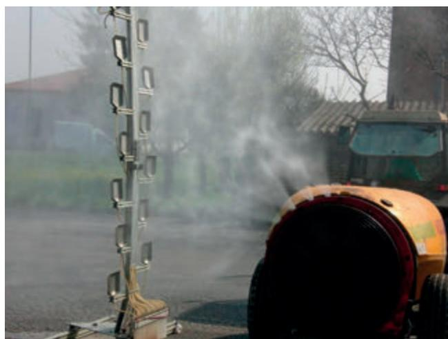
Figura 17. Determinazione dell'uniformità di distribuzione su atomizzatore ad aeroconvezione (Fonte: Bulzoni Meccanica sas).
