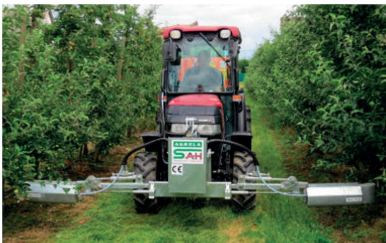
Figura 12. Barra schermata per diserbo sottofila in frutteto.
