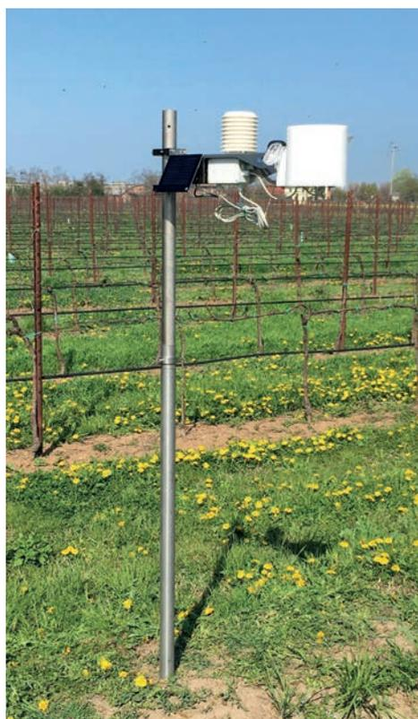
Figura 6. Stazione meteo Pessl utilizzata per la rete meteo Fitoclimate.
