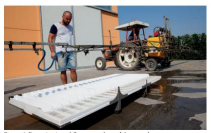
Figura 16. Determinazione della corretta altezza di lavoro su barra irroratrice (Fonte: Bulzoni Meccanica sas).
