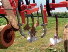
Figura 11. Irroratrice abbinata a seminatrice (sinistra) e irroratrice abbinata a sarchiatrice (destra).
