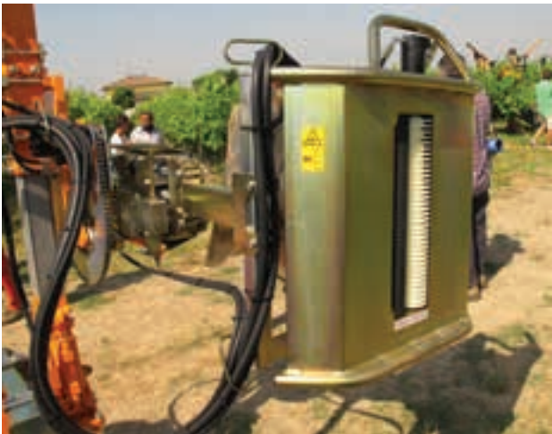
Figura 1. Defogliatrice Binger EB490S con testata ruotabile di 180°
