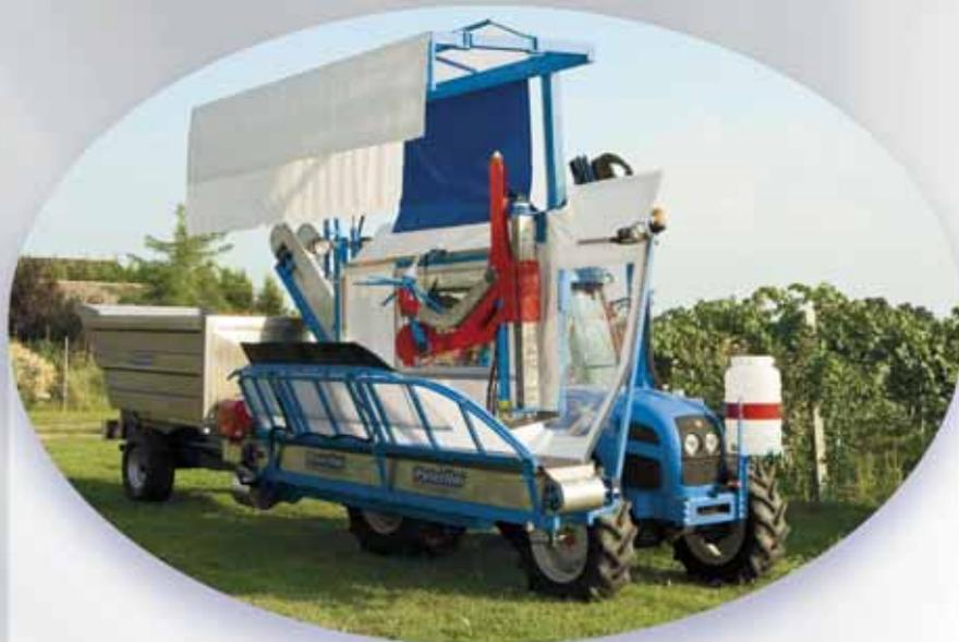
La vendemmiatrice MK 56 C può essere applicata a qualsiasi tipo di trattore a quattro ruote motrici avente una potenza non inferiore a 60-70 CV e munito di superriduttore. Questa nuova versione può essere applicata a trattori cabinati con ruote posteriori da 24". Tutti i suoi movimenti sono elettro-idraulici, la capacità di raccolta varia da 30 a 50 q/ora a seconda della produttività dell'impianto e del tipo di uva.
