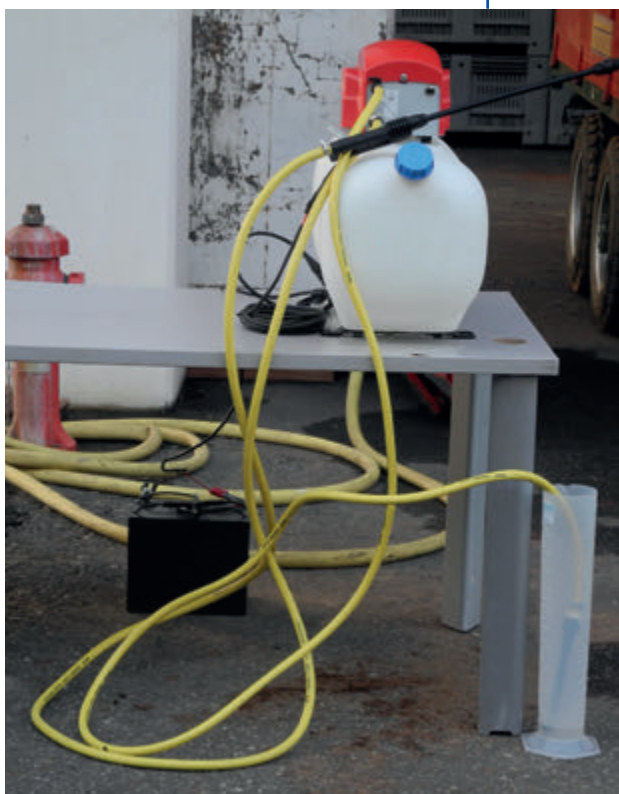
Figura 1: Botte da 15 litri ausiliaria da mettere sugli atomizzatori per poter lavare le botti in campo.
